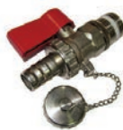
Котловска славина HD2232 , месинг, хромирана, максимален работен притисок 10 bar, максимална работна температура 110°C.
