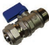
Мини вентил, комплет со адаптер (за полиетиленска цевка со алуминиумска влошка), HD 2266 , месинг, хромиран, максимален работен притисок 10 bar, максимална работна температура 110°C.
