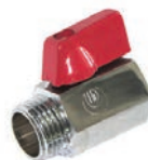
Мини вентил, HD 2260B , месинг, хромиран максимален работен притисок 10 bar, максимална работна температура 110°C.
