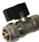
Мини вентил, комплет со адаптер (за полиетиленска цевка со алуминиумска влошка) HD 2267 , месинг, максимален работен притисок 10 bar, максимална работна температура 110°C.
