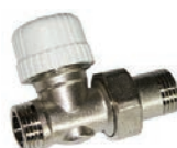
Радијаторски прав вентил, ICMA 773, за термостатска глава (M28 x 1,5), за адаптер ICMA 98 (1/2").
