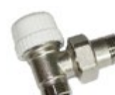
Радијаторски аголен вентил, ICMA 772, за термостатска глава (28 x 1,5), за адаптер ICMA 98 (1/2").
