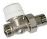
Радијаторски прав вентил, ICMA 771, за термостатска глава (28 x 1,5), за спојка ICMA 100 (M24 x 1,5).
