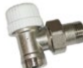
Радијаторски аголен вентил, ICMA 770, за термостатска глава (M28 x 1,5), за спојка ICMA 100 (M24 x 1,5).
